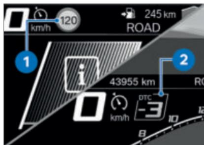
Ist Fahrmodus RACE PRO aktiviert, wird Speed Limit Info **1** ausgeblendet und
