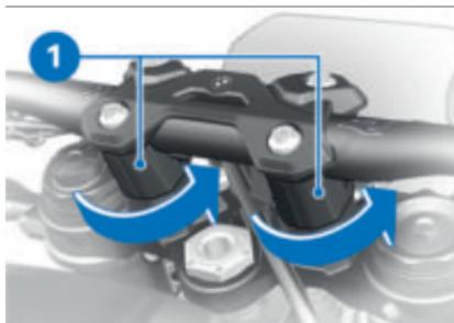
Die Lenkerposition ist durch Drehen der Lenkerböcke **1** um 180° in zwei Positionen einstellbar.
