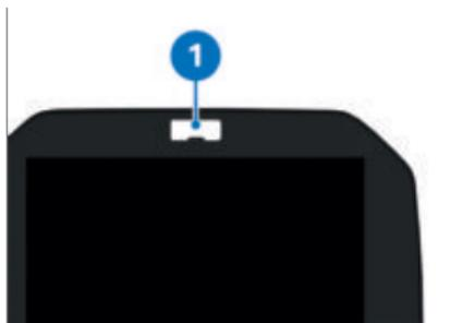
Der Schaltblitz **1** signalisiert dem Fahrer die Annäherung an die Drehzahl, bei der er in den nächsthöheren Gang schalten soll.
