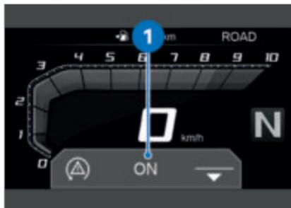
Mit dem ersten Druck auf die Multiwippe wird der aktuelle Systemzustand **1** angezeigt.
