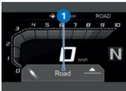
Die Dämpfung kann je nach Fahrmodus in unterschiedliche Settings **1** eingestellt werden.
