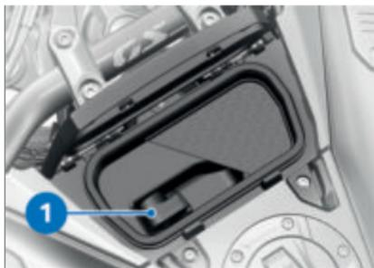
Es handelt sich um einen 5 V USB-Ladeanschluss **1**, der maximal 2,1 A Ladestrom (Ladeleistung maximal 10,5 W) zur Verfügung stellt.
