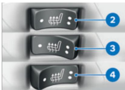
Der Soziussitz kann in zwei Stufen beheizt werden. Die zweite Stufe dient zum schnellen Aufheizen des Sitzes, an-
