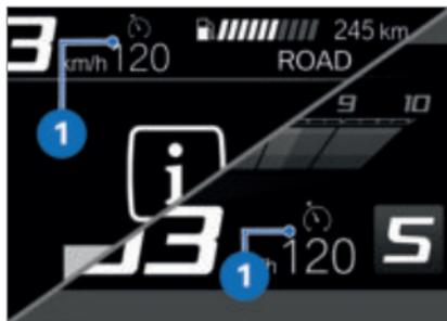
Das Symbol **1** für die Temporegelung wird in der Ansicht Pure Ride und in der oberen Statuszeile angezeigt.
