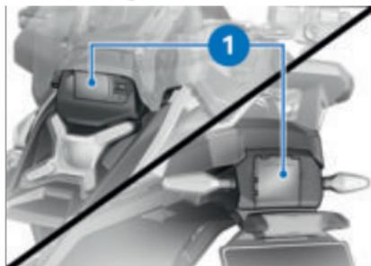
Abdeckungen **1** der Radarsensoren mit einem mit Glasreiniger befeuchtetem Tuch reinigen.
