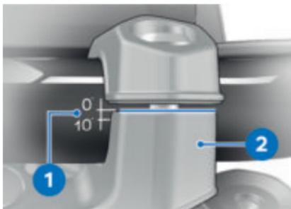
Der Lenker ist in den Bereichen der Markierung **1** in der Neigung einstellbar. Die Markierung **1** dabei an der Oberkante der Lenkerbrücke **2** ausrichten.
