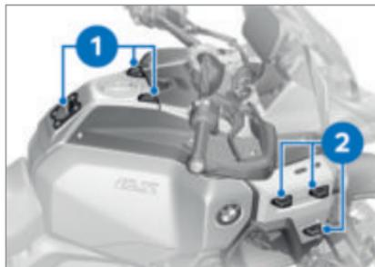
Zusätzliche Befestigungselemente an Tank **1** und Kühlerblenden **2** bieten die Möglichkeit BMW Motorrad Zubehör wie Tankrucksack und Kühlerblendentaschen anzubringen.
