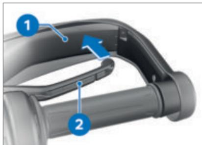
• Freigängigkeit zwischen Handschutz **1** und Handhebel **2** links und rechts prüfen. Berührt der Handhebel den Handschutz oder lässt sich der Handhebel aus der Ruhelage nicht leichtgängig nach vorn bewegen:
